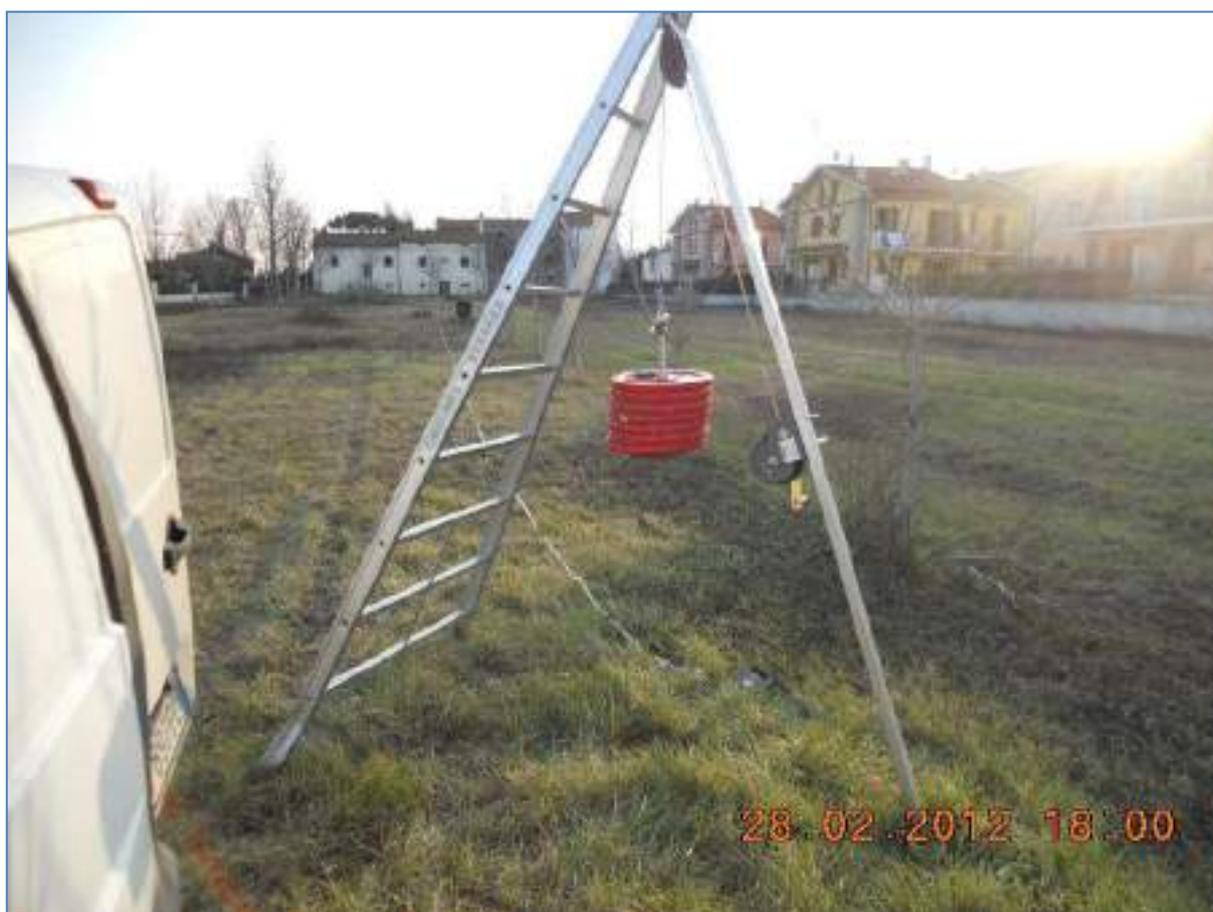
**Figura 1: Sistema di energizzazione da 90 kg**
