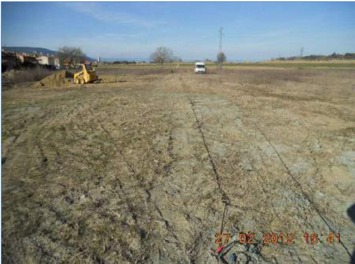
**Figura 56: Stendimento sismico a rifrazione ST1**
