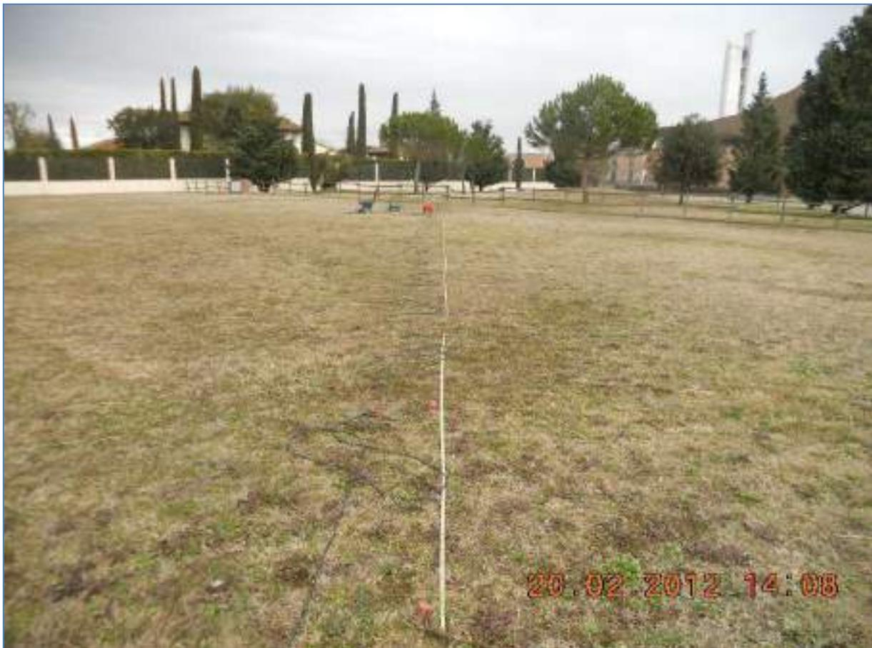
**Figura 2: Stendimento sismico MASW 1**
