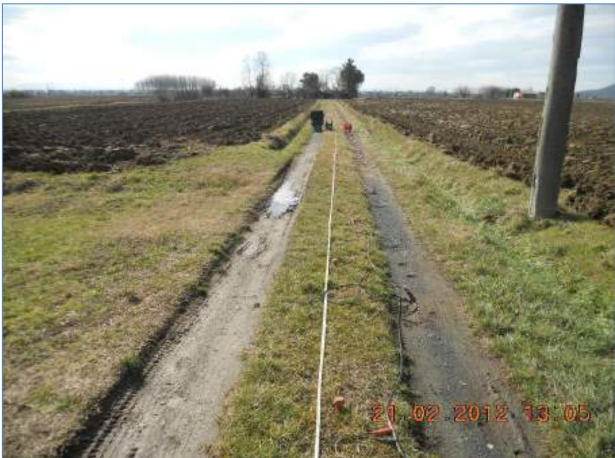
Figura 8: Stendimento sismico MASW 7
