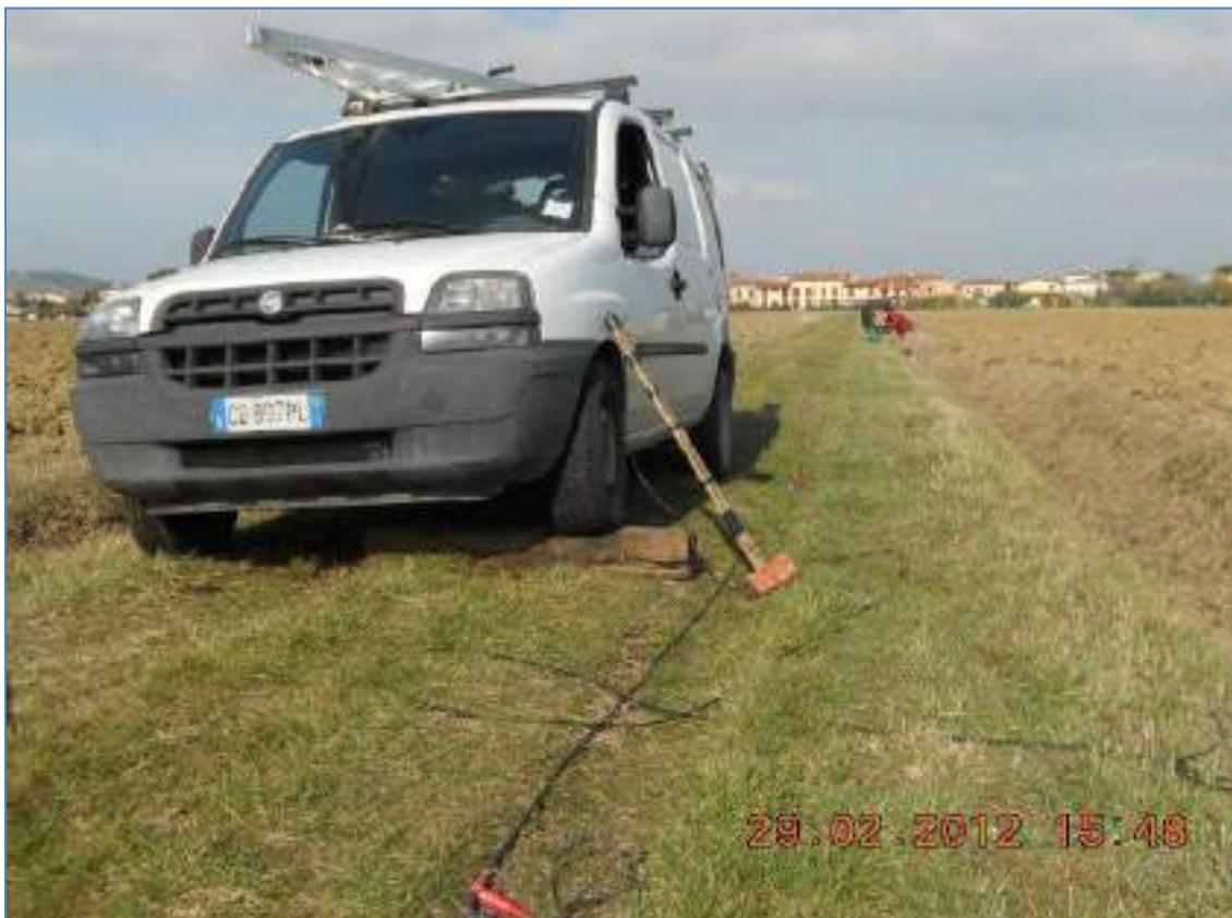
Figura 55: Sistema di energizzazione per le onde SH
