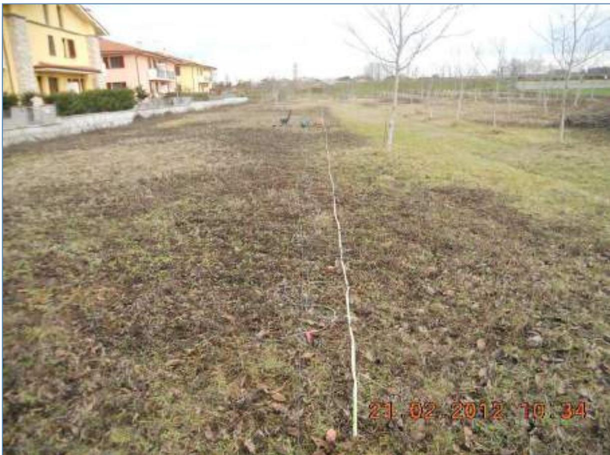
Figura 6: Stendimento sismico MASW 5
