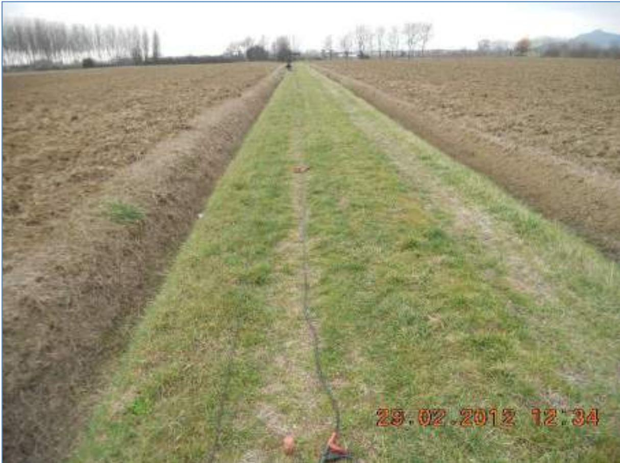
Figura 58: Stendimento sismico a rifrazione ST3
