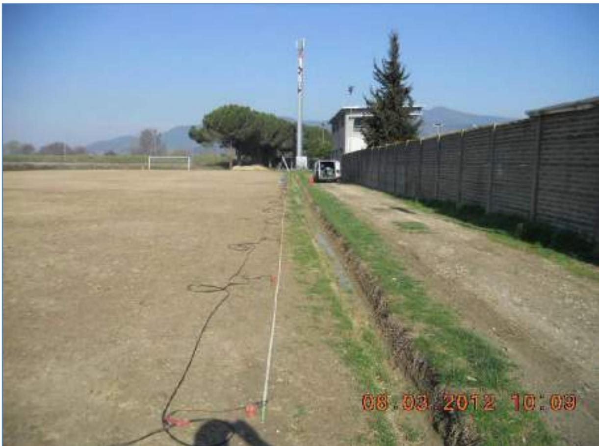
Figura 10: Stendimento sismico MASW 9
