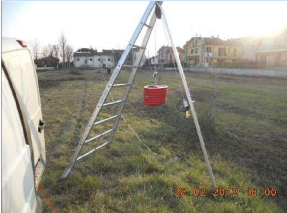
Figura 54: Sistema di energizzazione per le onde P
