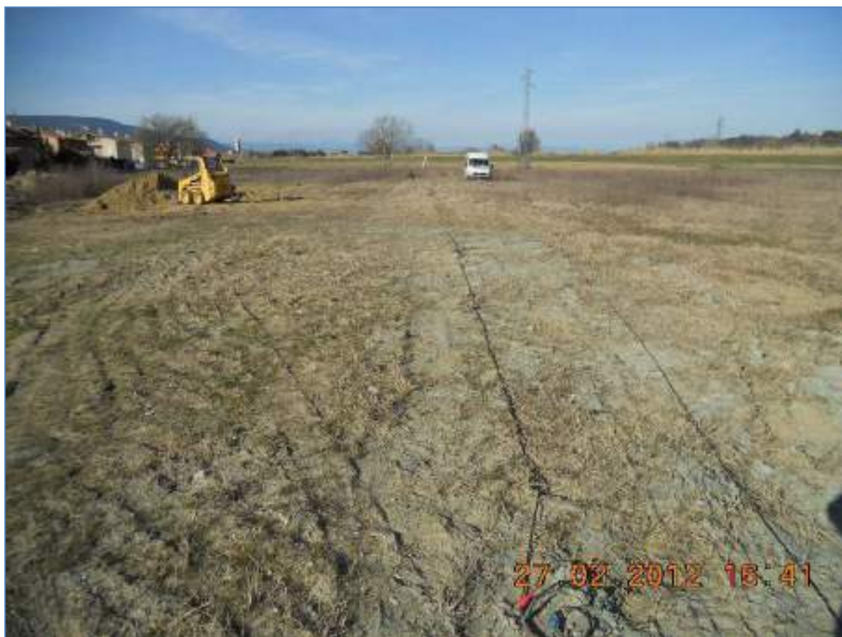
Figura 56: Stendimento sismico a rifrazione ST1
