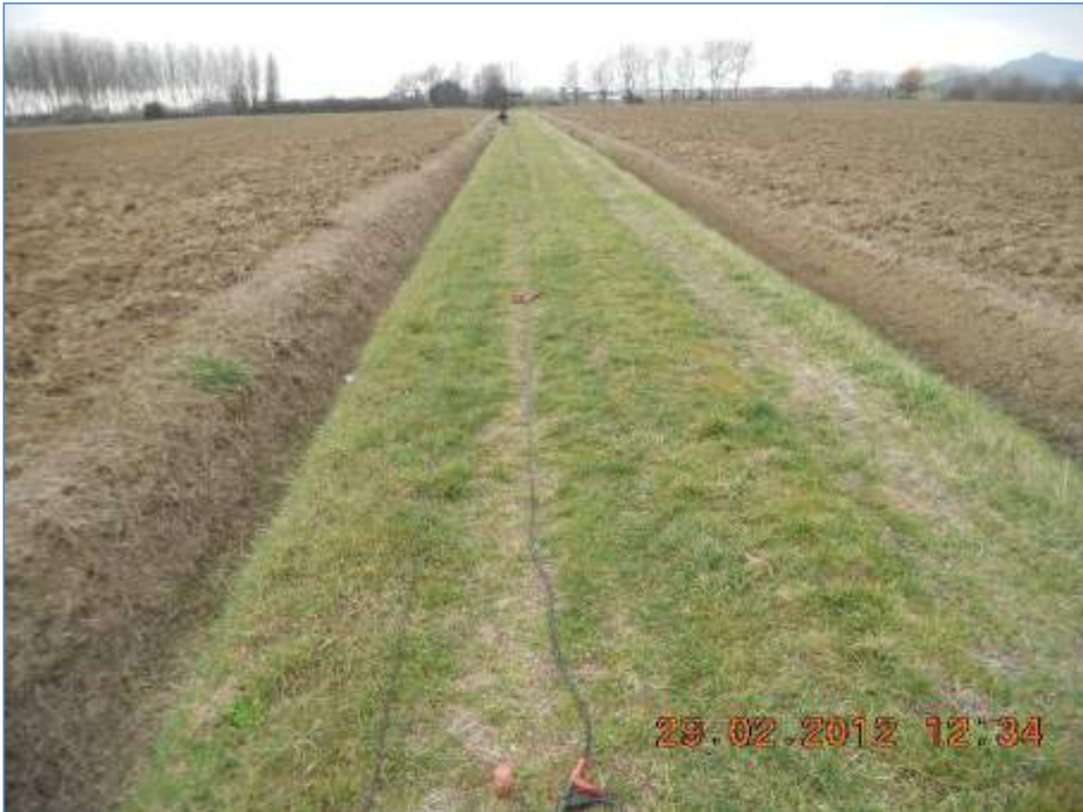
Figura 58: Stendimento sismico a rifrazione ST3
