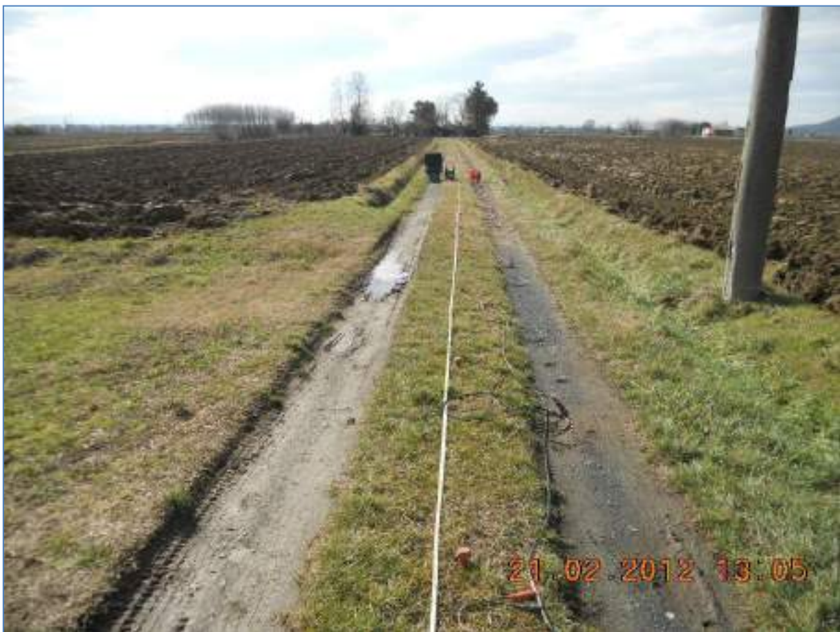
Figura 8: Stendimento sismico MASW 7
